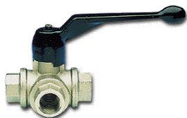
3/2 Wege Kugelhahn L-Anschluss, Messing vernickelt 4x PTFE-Dichtung
